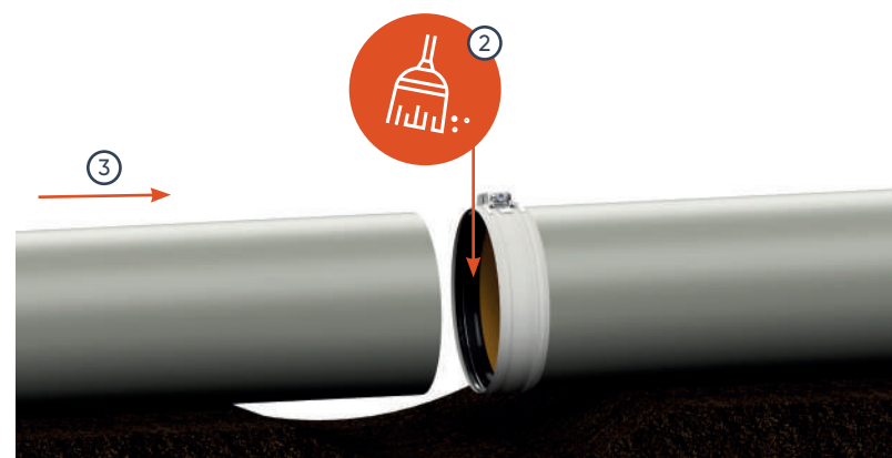
Mise en place des tuyaux dans la tranchée
