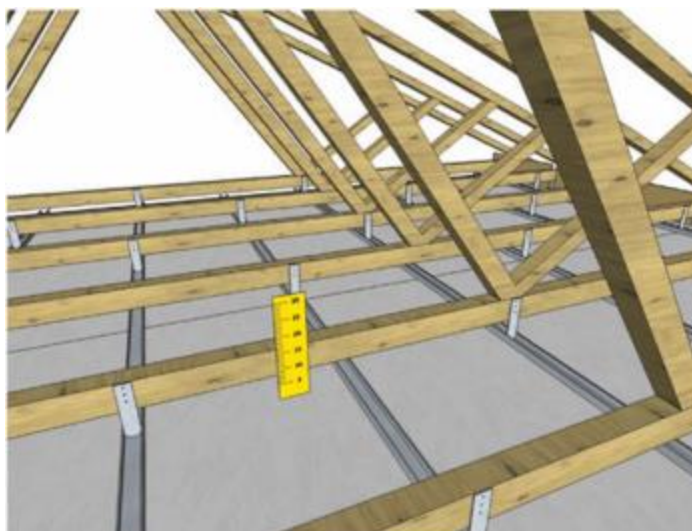
Figure 6 – Repérage de la hauteur d'isolant à souffler ou à épandre
