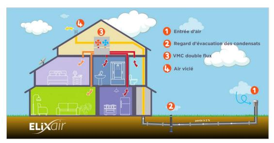
Le dimensionnement d'un puits climatique dépend du débit d'air maximal à assurer.
